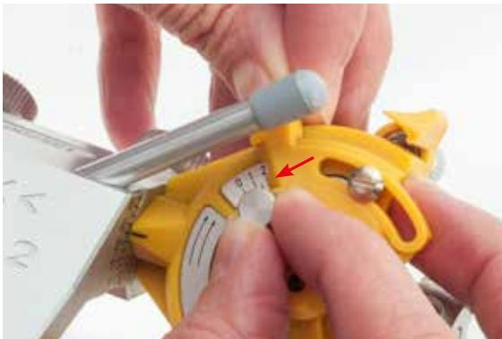
Eine Protrusion kann an einer Skala (Pfeil) bis zu 5,5 mm eingestellt werden. Der gewünschte Wert auf der Skala (hier zum Beispiel 2 mm) kann stufenlos eingestellt und mittels Schraube arretiert werden.
